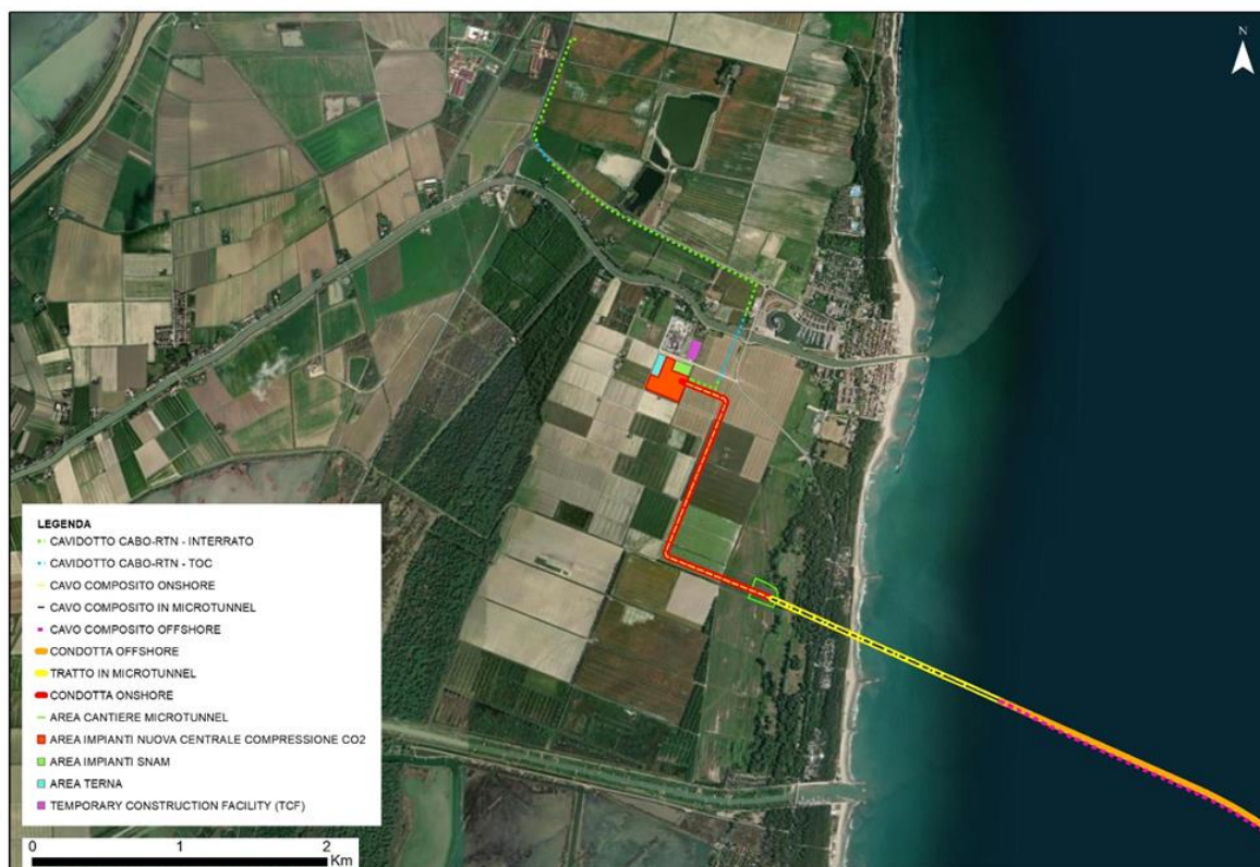
FIGURA 5: LAYOUT DELLA NUOVA CONDOTTA E CAVO ONSHORE
